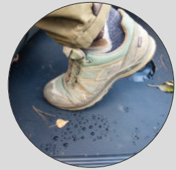
Anti-Rutsch Belag auf dem Bugbrett des Aluminiumbodens
